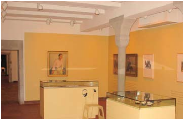
Die vier von der Bauer-Lüftungsanlage versorgten Ausstellungsräume sind hintereinander angeordnet. In den ersten drei Räumen erfolgt die Zuluftbringung hinter einer vorgesetzten Wand, im vierten Raum befindet sich die zentrale Abluftentnahme (in der Abb. oben rechts zu sehen).
